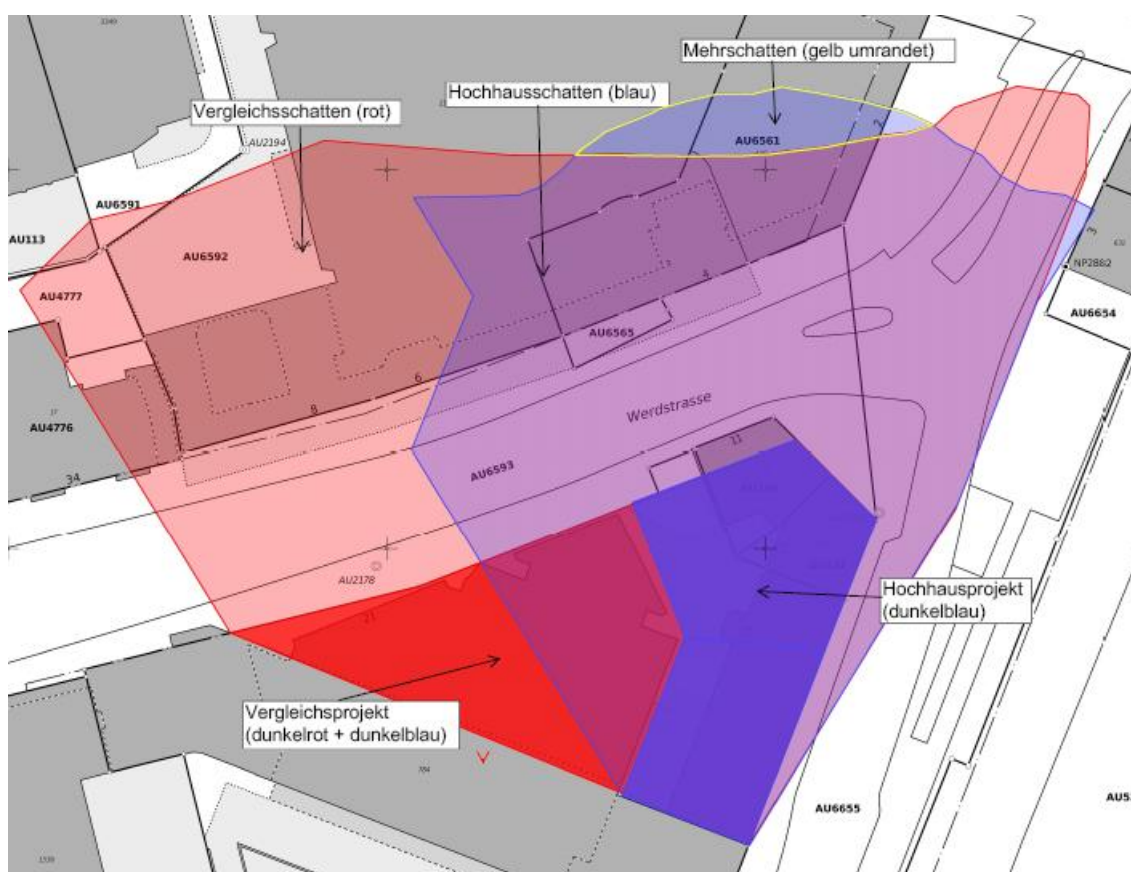
Abbildung 6: Schattendiagramm des im Jahre 2007 geplanten 38,64 m hohen Hochhauses der Tamedia AG, Projektion des Schattens auf die horizontale Ebene. Vermessung erfolgte durch Geomatik + Vermessung Stadt Zürich, GeoZ
